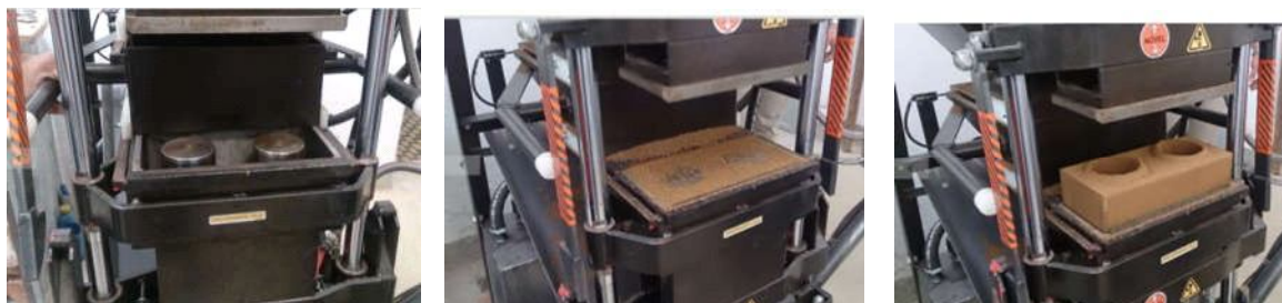
Figura 6. Procedimento de fabricação do Tijolo Ecológico.
