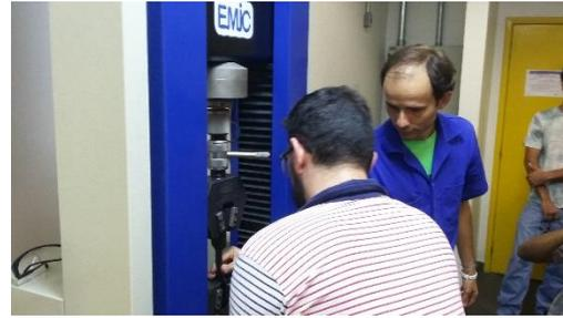
Figura 2 - Dimensionamento dos CPs (a) e fixação dos CPs na máquina de tração (b).
