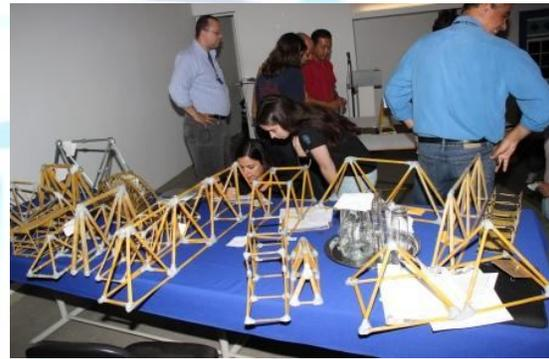
Resultado 3) Teste de ruptura com 55kg de carga máxima suportada.
