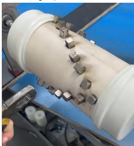
Figura 1 – Protótipo experimental de gerador por indução magnética com ímãs de neodímio dispostos em configuração helicoidal sobre tubo de pvc.
