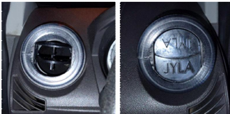
Figura 3 – Peça em PLA instalada no painel automotivo para validação funcional em uso real
