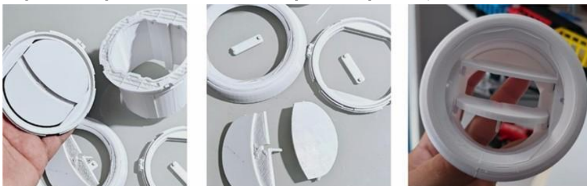
Figura 2 – Protótipo do difusor de ar-condicionado impresso em PP para validação dimensional e de encaixe.
