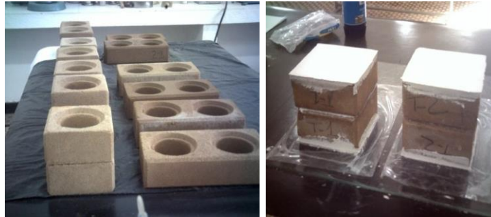
Figura 4. Sequência do procedimento de moldagem do tijolo ecológico.
