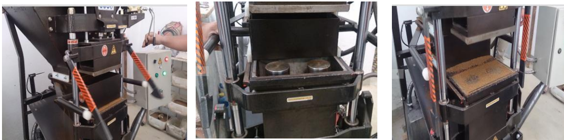
Figura 2. Sequência do funcionamento da caixa carregadora.
