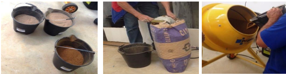
Figura 1. Sequência da mistura dos componentes para a confecção do Tijolo Ecológico.
