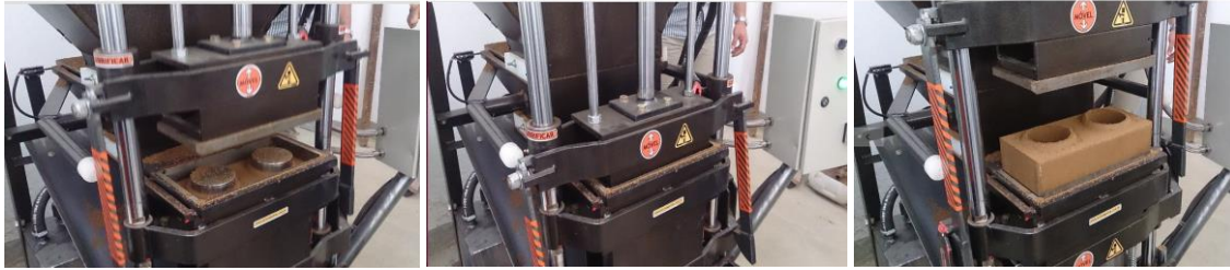
Figura 3. Sequência do procedimento de moldagem do tijolo ecológico.
