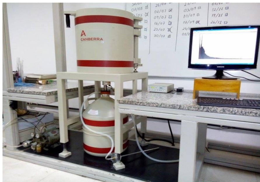
Figura 2. Espectrômetro de alta resolução equipado com HPGe instalado no LAASC/PEN/COPPE/UFRJ.
