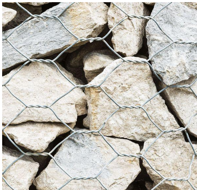
Figura 8. Malha metálica hexagonal de dupla torção
