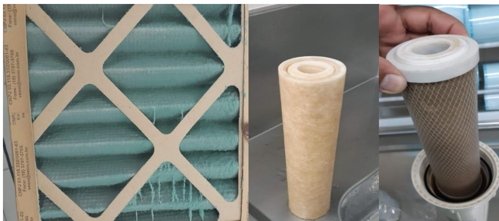
Figura 6. Filtro de proteção da autoclave de CME (Filtros de Osmose Reversa de Celulose e Filtro de carvão ativado)
