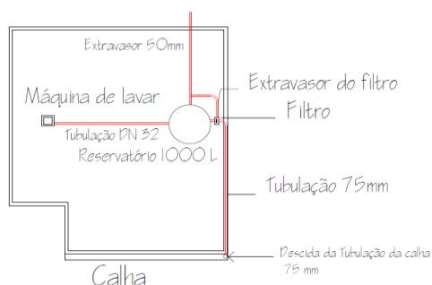
Figura 6. Detalhe de instalação
