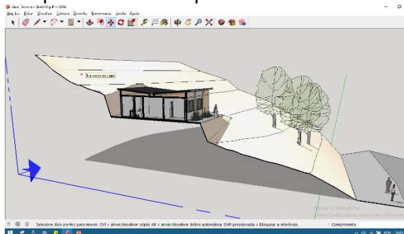
Figura 3. Simulação de seção transversal em terreno modelado desenvolvido com os alunos no SketchUP – ressalta-se a representação das Curvas de Nível componentes da maquete
