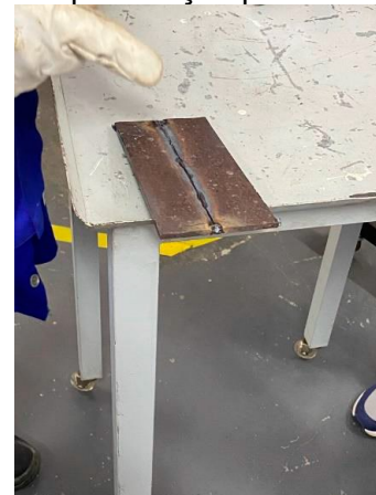
Figura 10. Parte inferior da solda, trechos com penetração parcial
