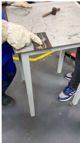
Figura 9. Cordão De Solda Com Inclusão De Escória
