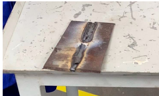
Figura 7. Cordão De Solda Sem A Remoção Da Escória
