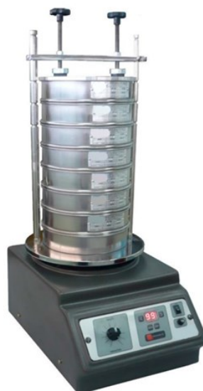
Figura 1. Série de peneiras, agitador, tampa e fundo
