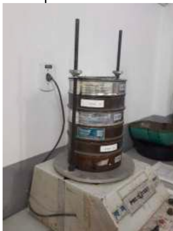
Figura 5. Execução do peneiramento
