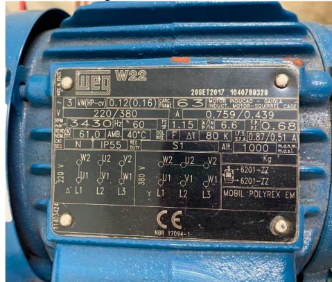
Figura 6. Placa de identificação do motor WEG W22 utilizado na prática
