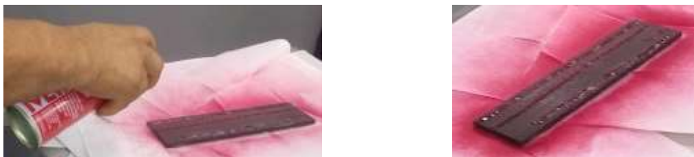
Figura 7 – Aplicação do líquido penetrante Metal-Chek VP 30
