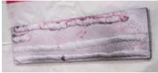
Figura 8 – Amostra após aplicação do revelador
