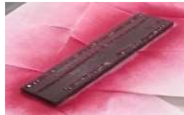
Figura 6 – Aplicação do líquido penetrante Metal-Chek VP 30
