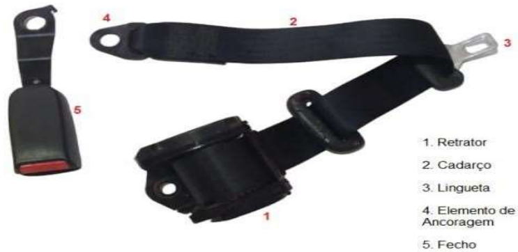
Figura 1: Elementos que constituem o cinto de segurança veicular.
