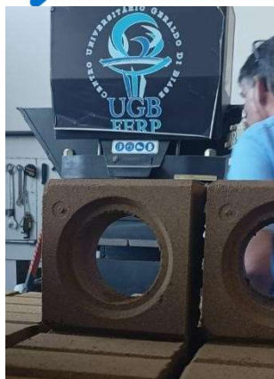
Figura 1 – Tijolos moldados pela prensa hidráulica
