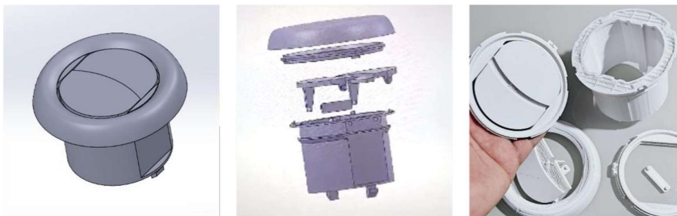
Figura 1 – Protótipo do difusor impresso com material PP
