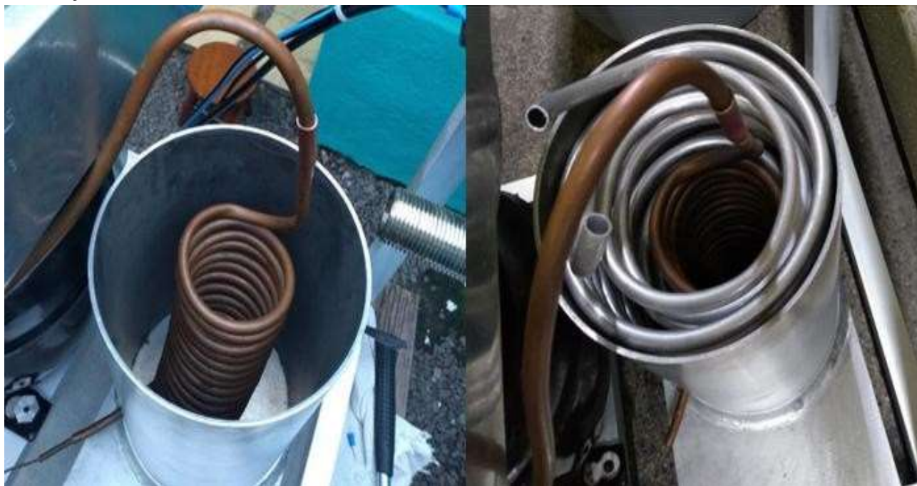
Figura 2: montagem do sistema de refrigeração da chopeira
