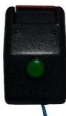
Figura 4: acionamento do sistema elétrico, para alimentação do sistema de destravamento.
