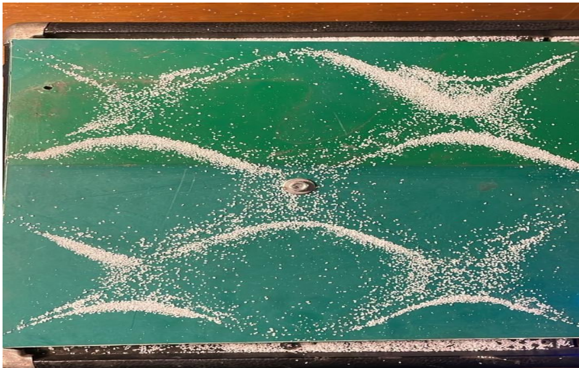
Figura 6. Experimento de Chladni com 186Hz (Costa et al, 2025)
