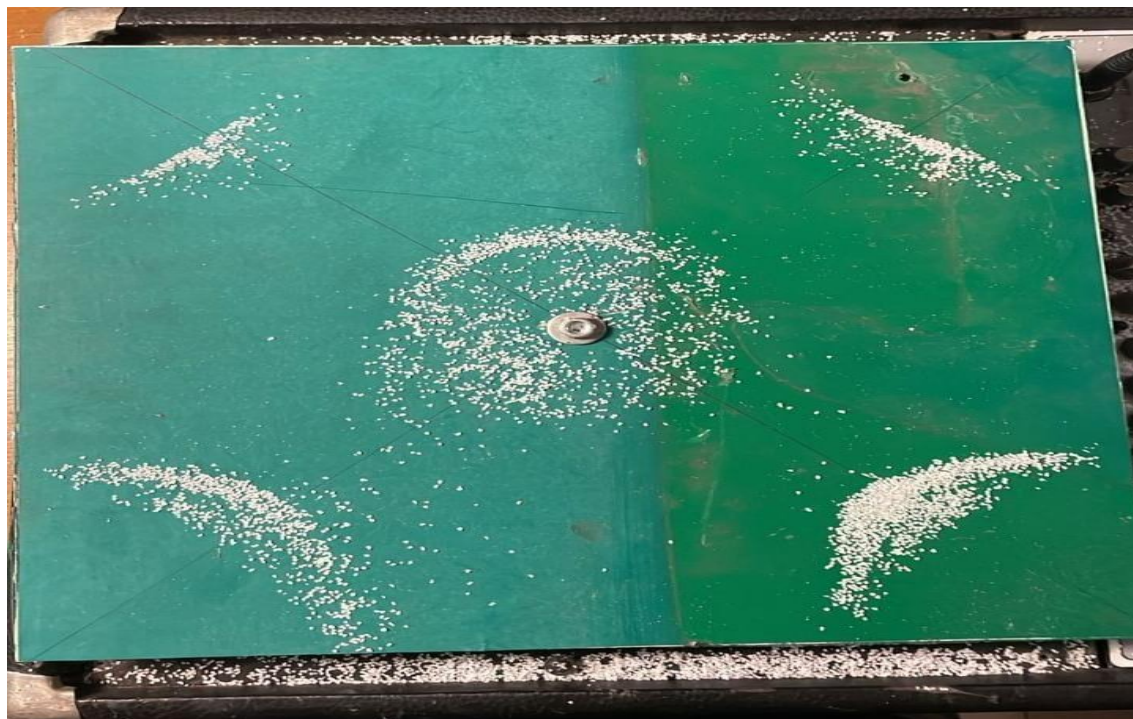
Figura 4. Experimento de Chladni com 78Hz (Costa et al, 2025)
