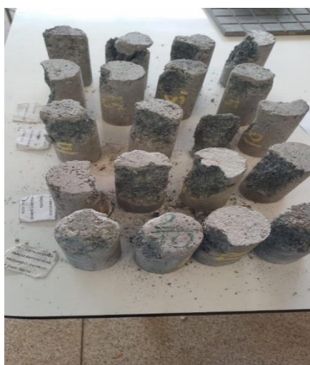
Figura 1 – Modos de rupturas observados
